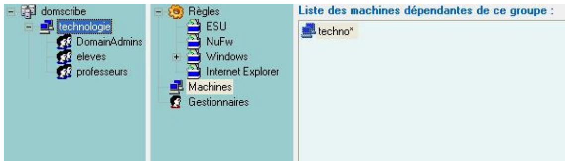
Utilisation du joker (*) pour paramétrer les noms de machines prises en compte par le groupe
